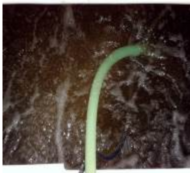
hladina při správné funkci provzdušňování
